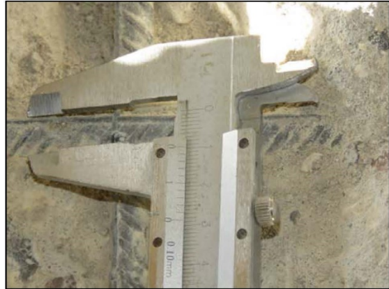
ФОТО 14. Уточнение диаметра рабочей арматуры напольной поверхности железобетонной плиты перекрытия подвала между осями «Б/2»-«В/2» и «7»-«8».
