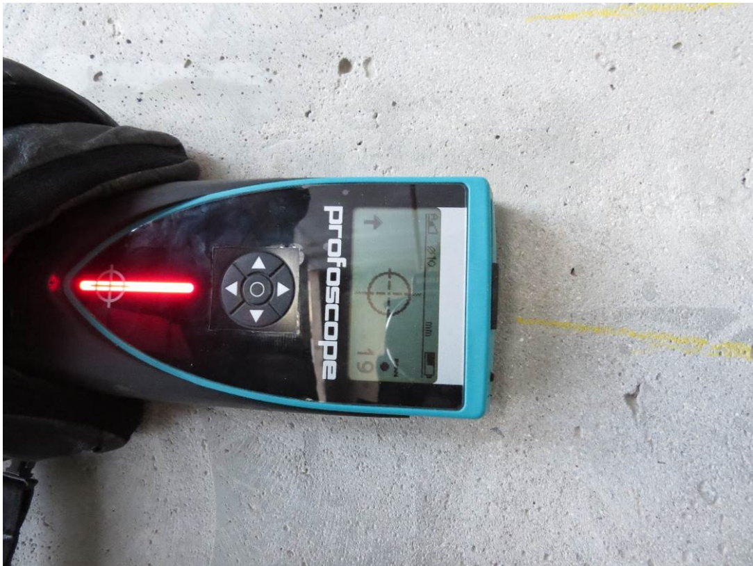
Рис. 3.2.5. Определение расположения армирования и толщины защитного слоя бетона выполнено при помощи магнитного прибора «Profoscope» по оси 16 между осями Ю-Я на отм. -0,300 м
