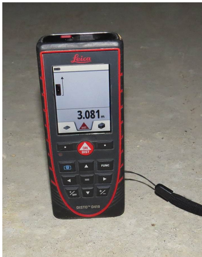
Рис. 2.4. Замер высоты помещений подвального этажа секции №4 при помощи лазерного дальномера Leica DISTO D410
